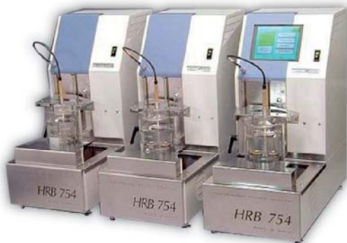
Do jednostki głównej, z wbudowanym komputerem, można podłączyć dwie tańsze jednostki bez komputera.
